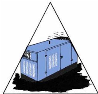
Неровная или загроможденная площадка. Неправильное основание генераторной установки
